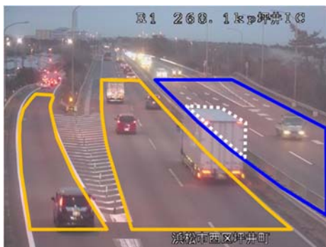
図-8 大型車の荷台のはみ出しによる誤検知。
