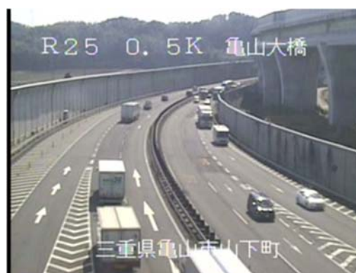
図-13 逆走・誤進入の検知に適した画角の例。
