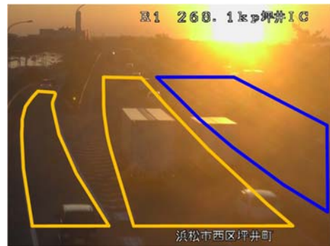
図-10 朝日の逆光による誤検知。
