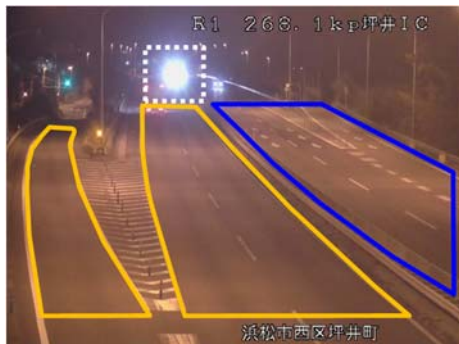
図-9 対向車線のヘッドライトによる誤検知。
