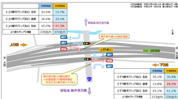
図-18 上野東IC 交通転換図
