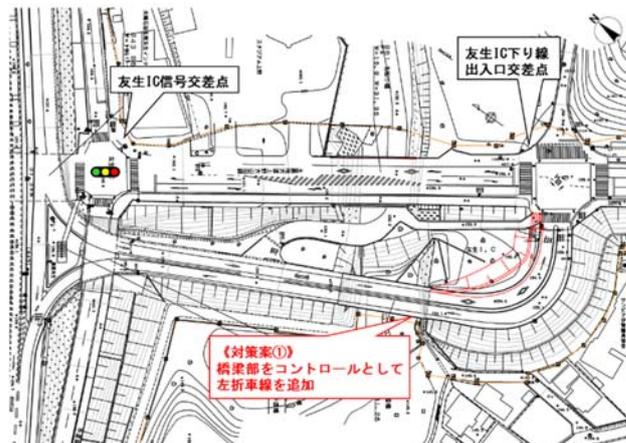
図-8 下り線左折レーン設置図
