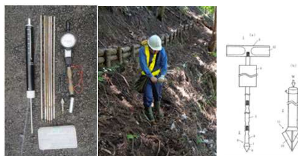
図-9 土層強度検査棒
