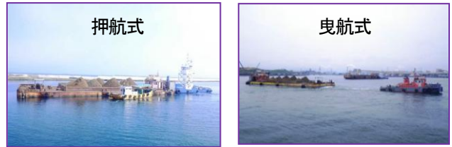
写真-13 土運船による運搬状況
