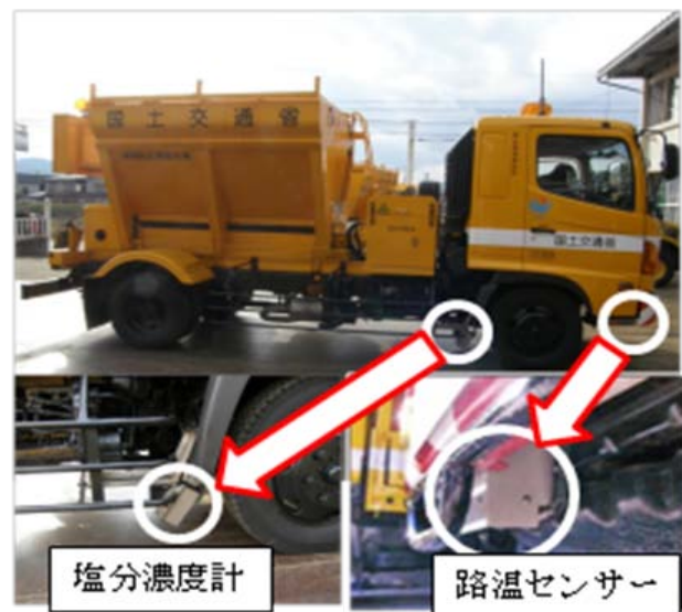
写真-1 機器設置状況
