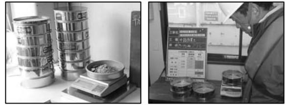
写真-5 室内粒度試験（左）と現場簡易測定（右）
