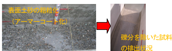
図-5.12 土砂の排出状況
