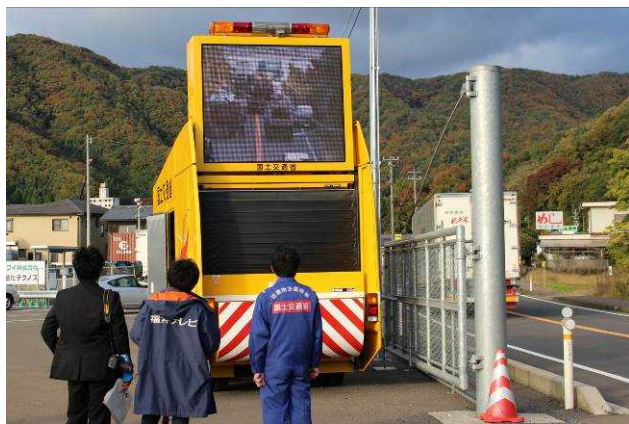
写真-4 高機能標識車によるライブ映像表示状況
