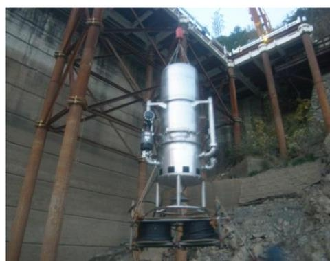
写真-3 高濃度酸素水供給装置
