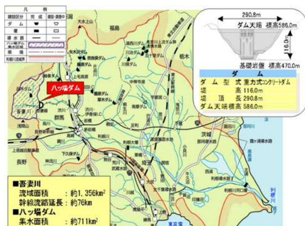
図-1 ハッ場ダム位置図・ダム諸元
