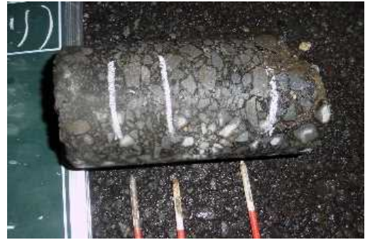
写真-2 コア写真 (正常部)
