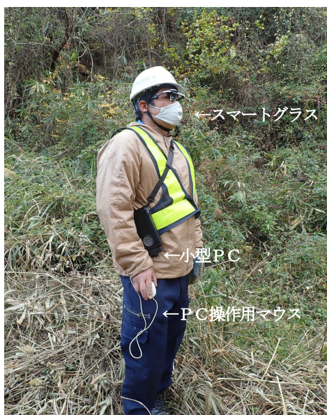
写真-2 リモート撮影器具の装備状況
