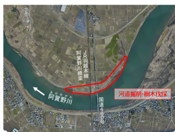
図-8 河道掘削・樹木伐採範囲
