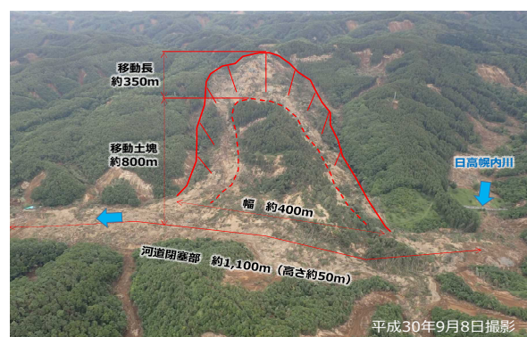
図-2 大規模河道閉塞（日高幌内川）
