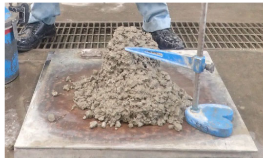
写真-6 細骨材の40%を軽石で体積置換した配合のスランブ試験後の状況
