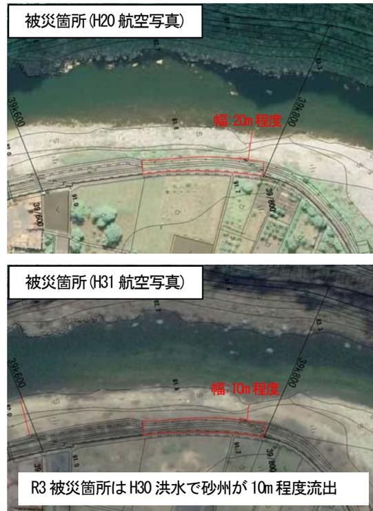
写真-4 被災箇所の航空写真(上:平成20年,下:平成31年)
