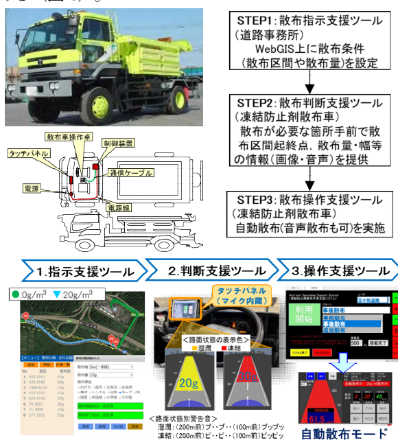
図-6 凍結防止剤散布支援システム（AIS3）の概要
