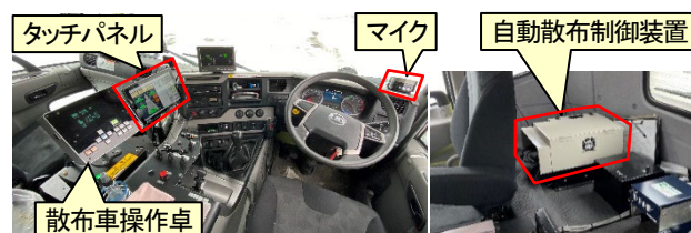
図-10 凍結防止剤散布車への凍結防止剤散布支援システムの搭載状況
