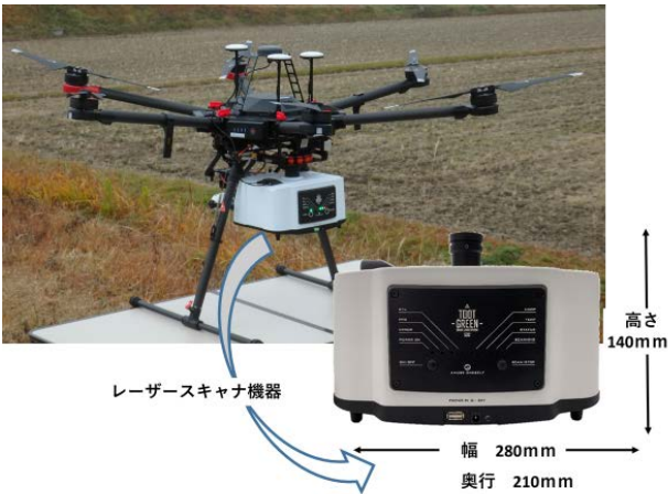
図-1 グリーンレーザスキャナとドローン全体の概観
