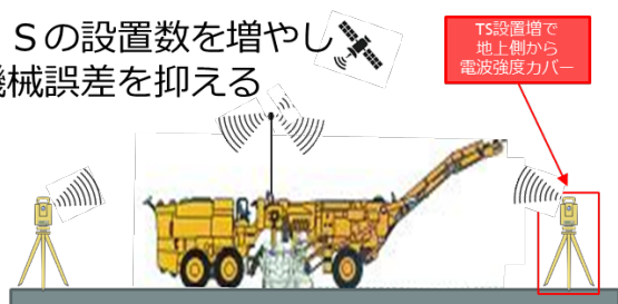
図4 TS設置数増による電波強度確保の概念図
