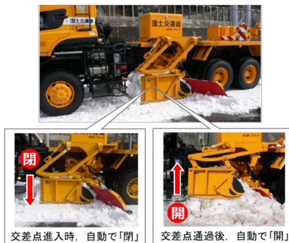
写真-3 サイドシャッターの動作
