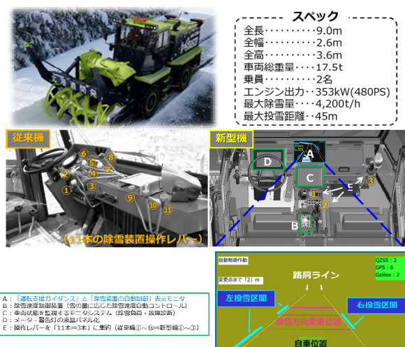
図-5 i-Snowロータリ除雪車の概要
