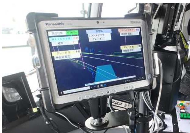
写真-2 自動制御装置
