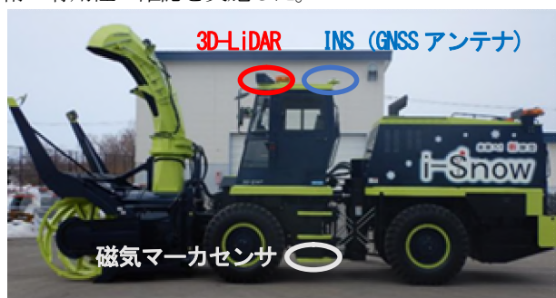
図-12 「i-Snowロータリ除雪車」への不感地帯対策技術の設置状況
