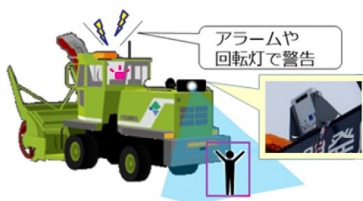
図-8 3DカメラとAI物体認証を有した接触防止システム
