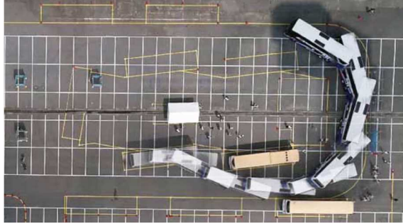
写真-2 ドローンによる走行軌跡撮影
