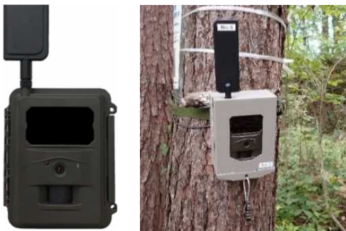
写真4 通信機能付きセンサーカメラ
