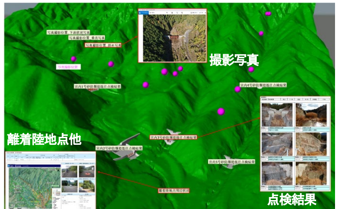
図-10 CIM 統合モデルを用いた UAV 点検データの利活用方法
