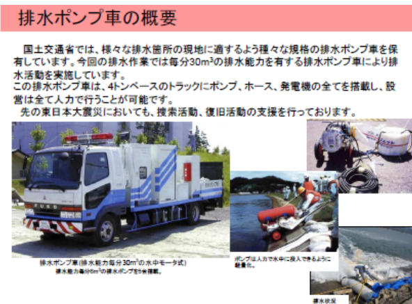
図-2 排水ポンプ車概要説明資料
