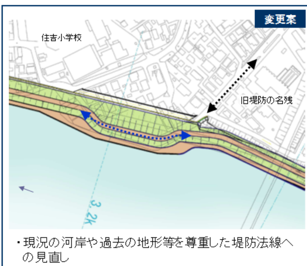
図-4 住吉地区(堤防法線見直し後)
