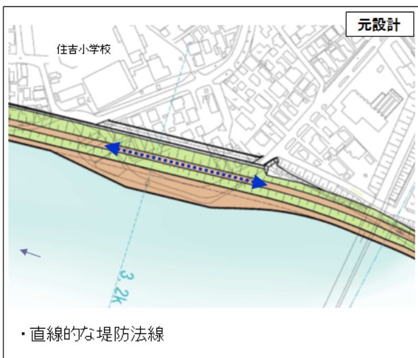
図-3 住吉地区(堤防法線見直し前)
