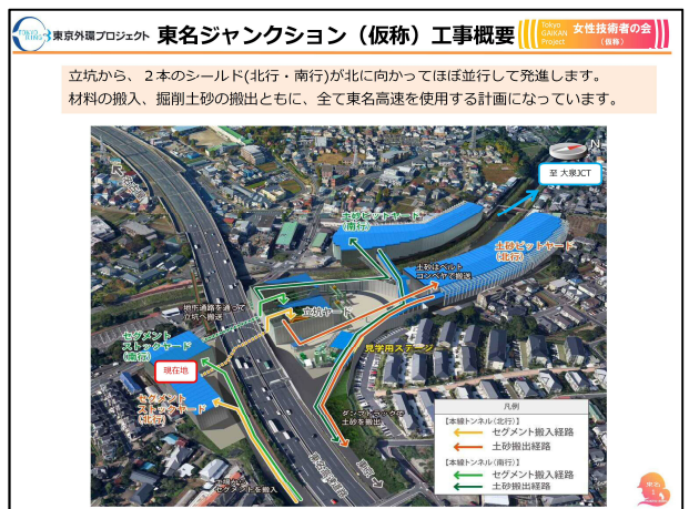
図-17 東名JCTの工事状況説明用パネルの一例
