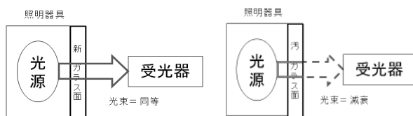
図-3 光透過率試験イメージ
