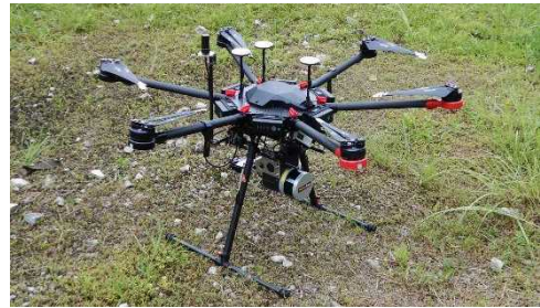
図-3 UAV及び計測装置
