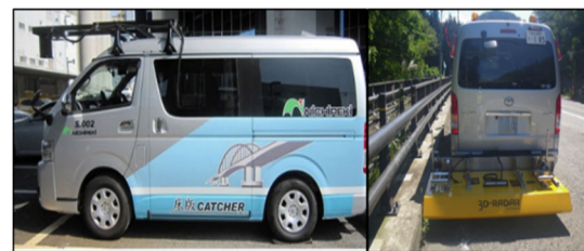
写真-3 車載式電磁波レーダ外観
