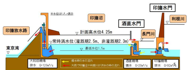
図二 印旛沼の水位管理
