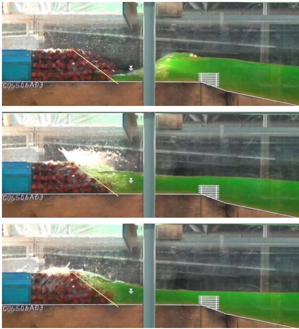
写真-6-1 消波工拡幅護岸の越波状況 ( H_{1/3}=1.30 m)
