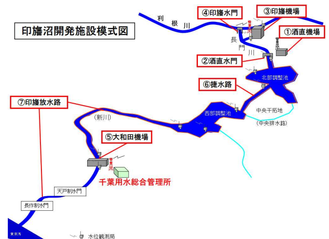
図一 印旛沼開発施設模式図
