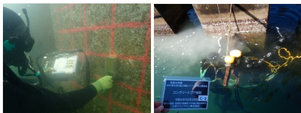
図-6 コア採取（左：水中鉄筋探索、右：スリット部採取）
