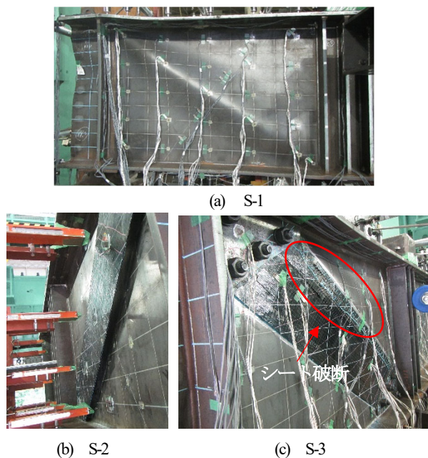
図-6 載荷試験終了時の破壊モード
