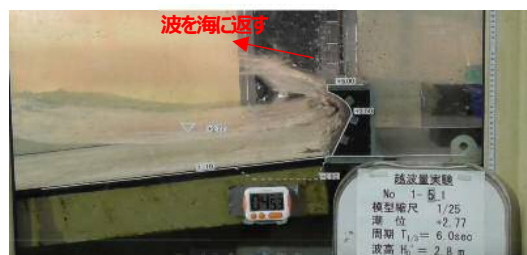
図-7 フレア式護岸水理模型実験状況
