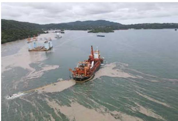
図-2. 2 砂利採取運搬船による軽石回収状況
