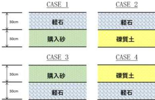
図-7 試験施工軽石改良敷均しケース
