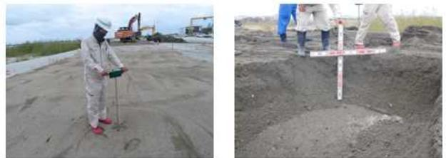
図-10 ポータブルコーン貫入試験（左側写真）と混合状況写真（右側写真）
