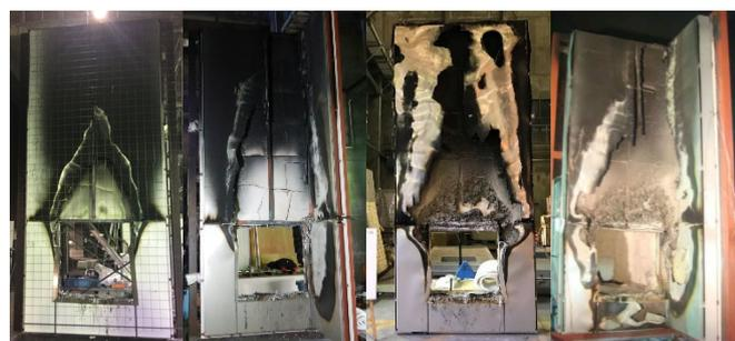
図-11 試験後の焼損状況 (袖壁の有無)
