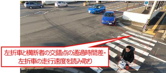
図-11 AI画像解析による自動車と横断者の交錯状況の読み取り
