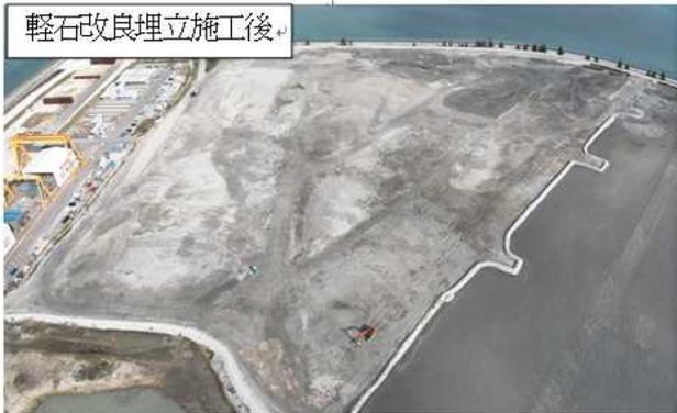
図-11. 2 軽石改良埋立箇所全景（施工後）
