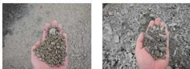
図-8 軽石（左側写真）と礫質土（右側写真）
