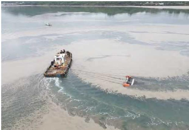
図-2. 1 小型船+回収器具による軽石回収状況
