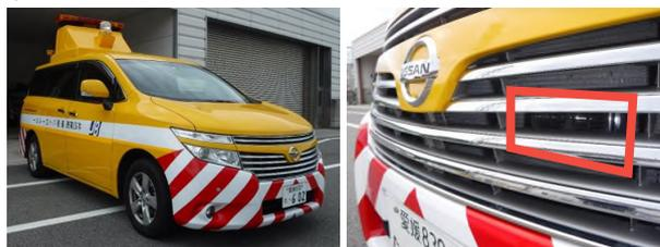
写真-7 道路巡回車への鹿ソニック取付状況
