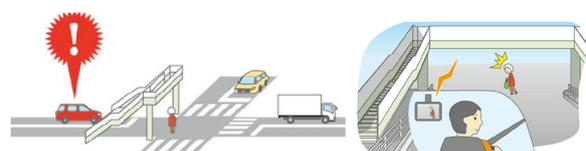
図-2 DRIVE CHARTによる危険事象の検知イメージ<sup>1)</sup>
