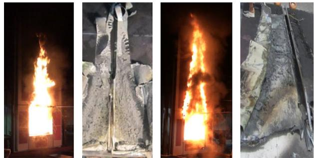
図-8 PVシートを張り付けた試験体の試験時の様子
