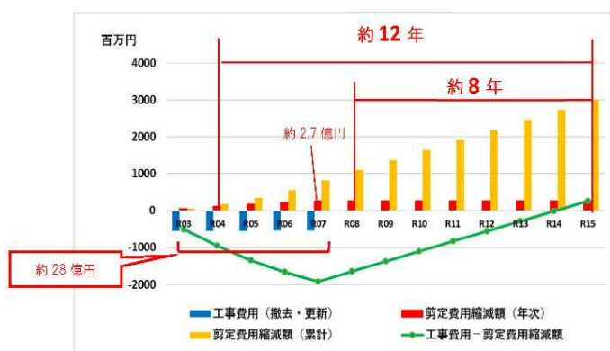
図-10 剪定費用の縮減額と工事費の回収（5年間）
