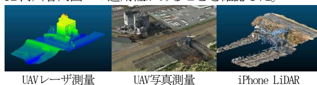
図-2 測量の試行例（河原田排水樋管）
