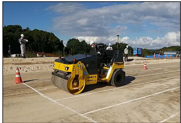
図-2 4t 振動コンバインドローラ(TW504)
