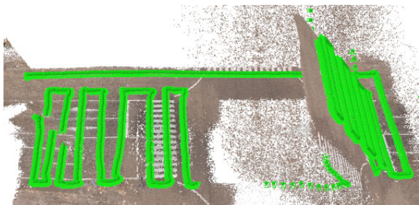
図-3 斜め下(俯角45度)に向け撮影した際の点群データ出力結果
