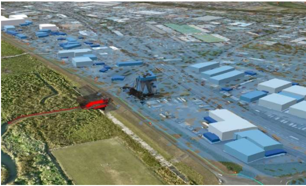
図4 3D河川管内図 浸水想定レイヤの表示
