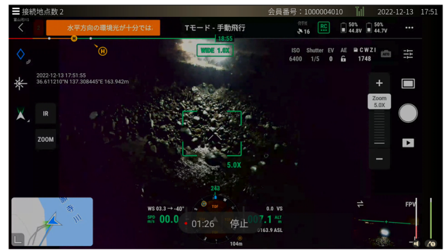
図-9 UAV 情報を表示している操作者の伝送画像の一例
