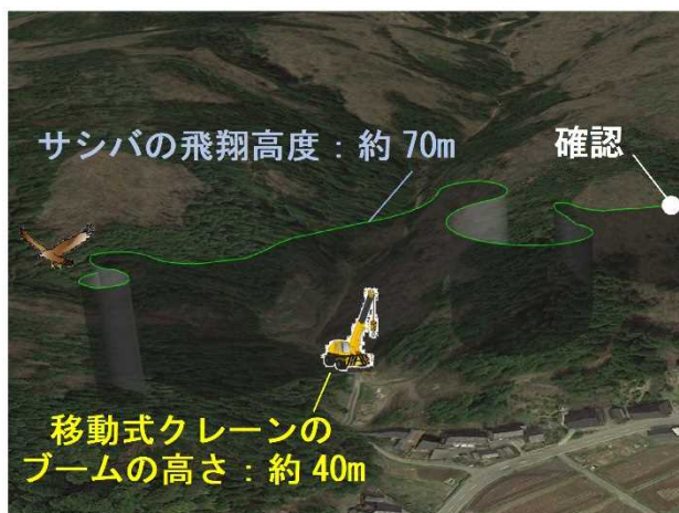
図-2 レーザー観測システムより作成した3次元飛行線図
