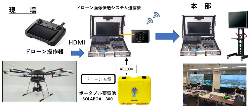
図-9 ドローン画像伝送システムの概要
