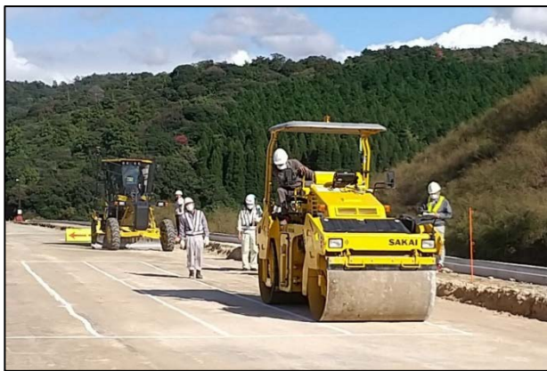
図-1 6.5t 振動タンデムローラ(SW654)
