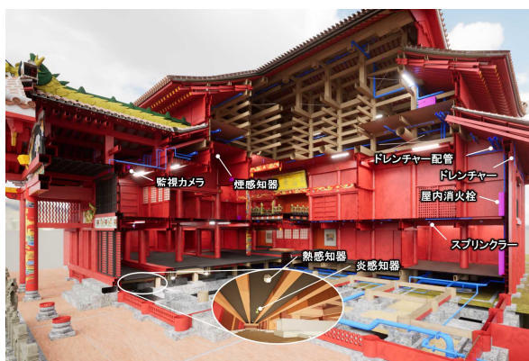
図5 防災設備設置箇所イメージ
