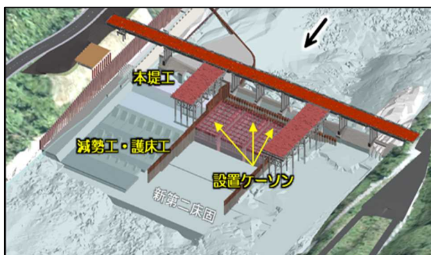
図-2 新第二床固改築工事概要図
