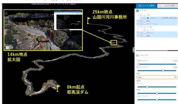
図-6 VTOL機により取得した25km区間の三次元点群データ
