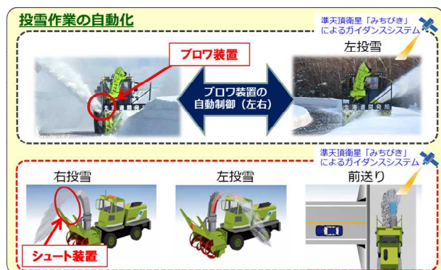
図-3 ロータリ除雪車投雪作業の自動化
