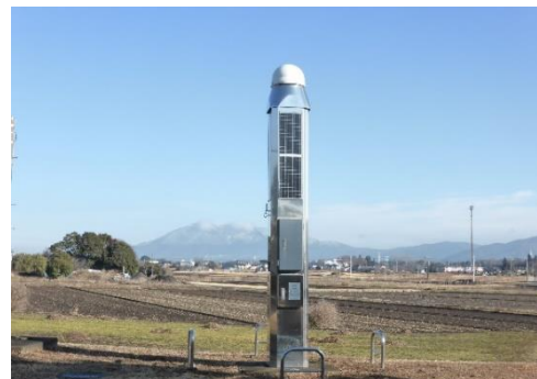
図-1 電子基準点「つくば1」の外観。約5mのピラーの上部にGNSSアンテナが設置されている。
