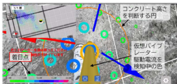
写真5 締固め打設者スマホの画面 (締固め中)
