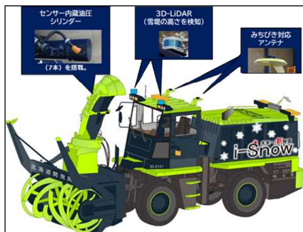
図-4 自動化に関する設置機器
