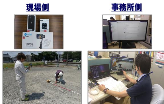
写真-1 簡単に操作できる遠隔臨場資機材
