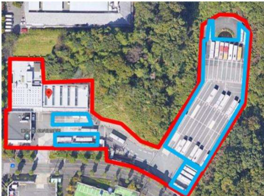
図表 8-6. 都心部駐車場での縦列配置事例（東急バス虹が丘営業所）
