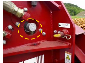
写真 7 土砂の含水状態により回転数を調整(20~30回/分)
