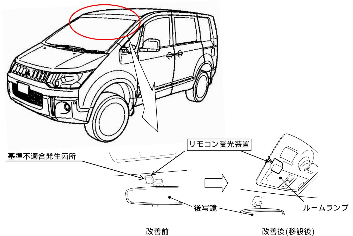
地上デジタルテレビ受信機を装着した特別仕様車において、当該受信機用リモコンの受光装置が前面ガラスに貼付けられているため、道路運送車両の保安基準に適合しない。
