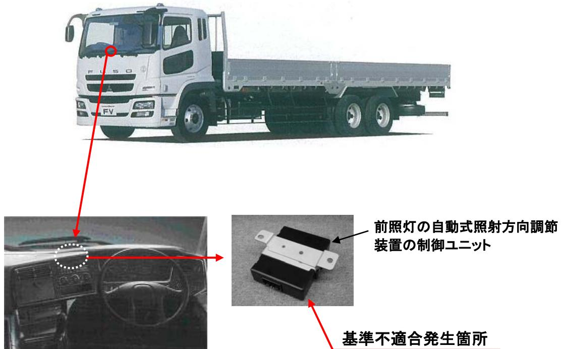
高輝度放電式（HID）前照灯の自動式照射方向調節装置の制御ユニットのデータに不適切なものがある。そのため、前照灯の光軸が自動調整されない場合がある。
