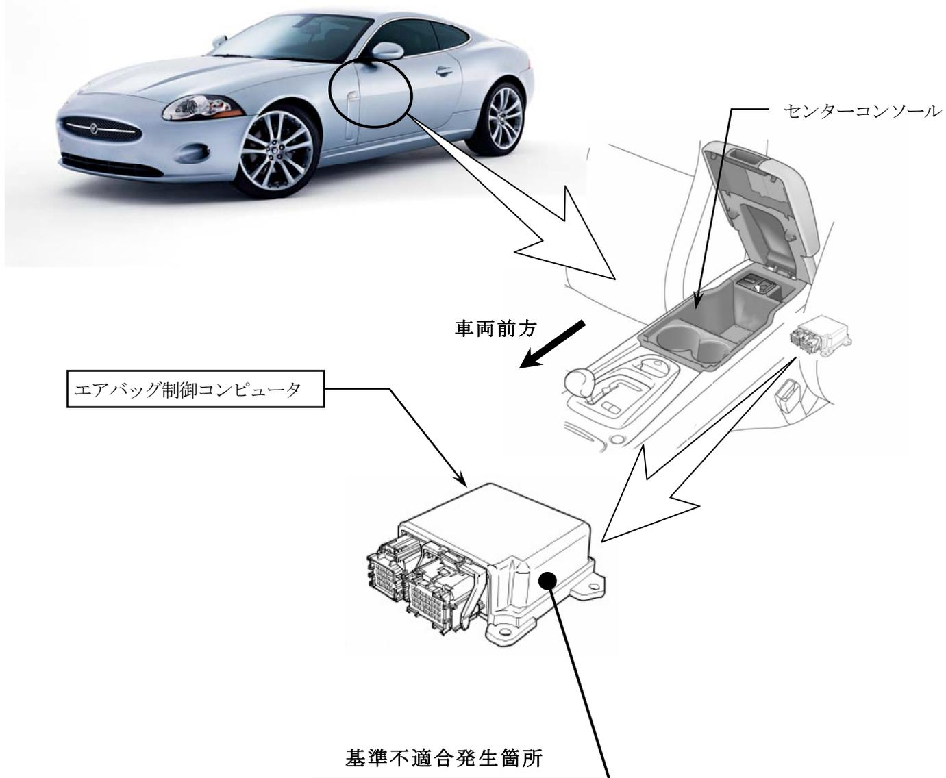
右ハンドル車両のエアバッグ制御コンピュータにおいて、製造時に左ハンドル用のプログラム設定が行なわれたため、助手席に同乗者がいない場合、右側（運転者席側）の側面衝突時に運転者席側サイドエアバッグが展開しない。
