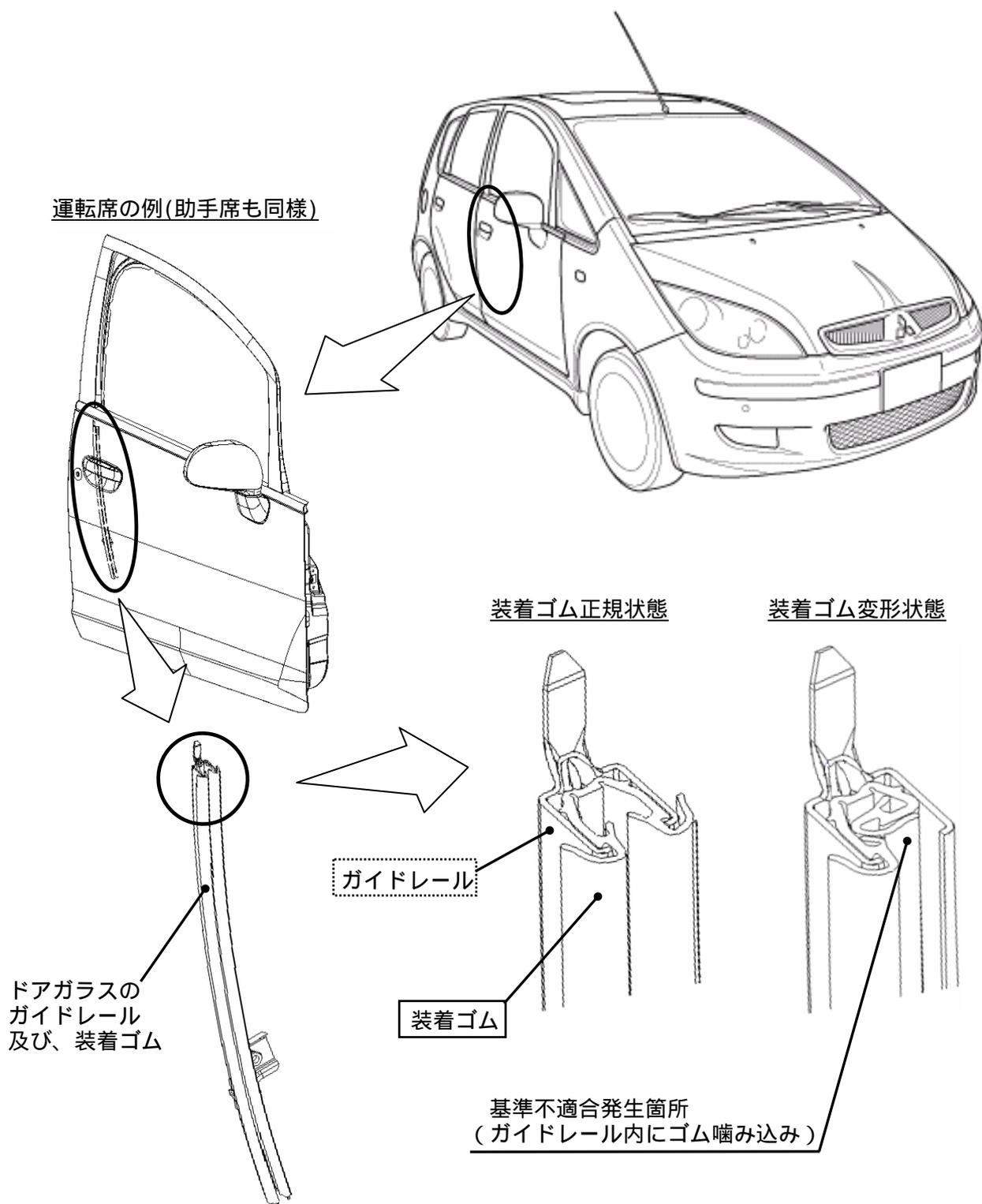
前席ドアガラスの組付け作業が不適切なため、ドアガラスのガイドレール内に装着されたゴムが変形しているものがある。そのため、そのまま使用を続けると、ドアガラス昇降操作の繰り返しにより当該ゴムが噛み込み、最悪の場合、ドアガラスを下げた際、ドアガラスがガイドレールから外れドア開閉用ロッドに干渉し、ドアが開くおそれがある。
