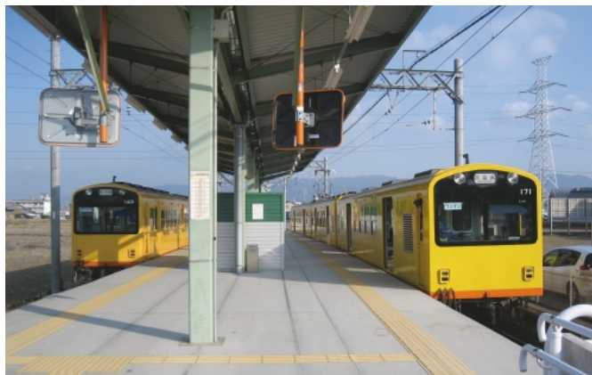
三岐鉄道北勢線。全国でも珍しいナローゲージと呼ばれる軌間762mmの路線で、一般の車両より少し小さい
