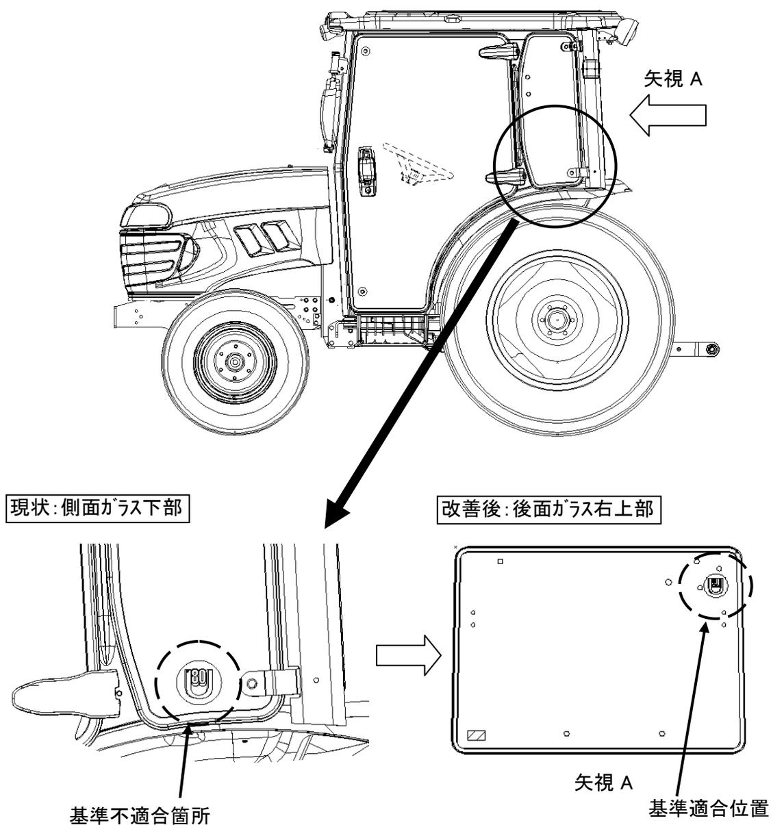
側面ガラスに銘板を貼付したため道路運送車両の保安基準に適合していない。
