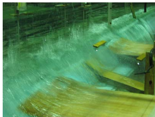
写真-3 波作用状況 (津波高 4m)
