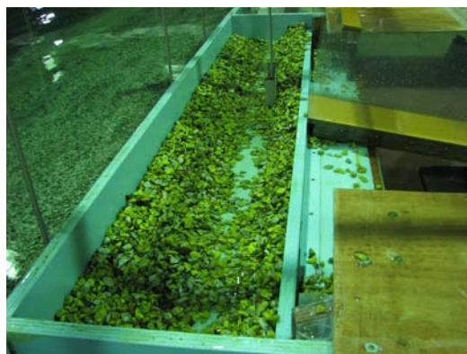
写真-4 石材飛散状況 (津波高 2m)
