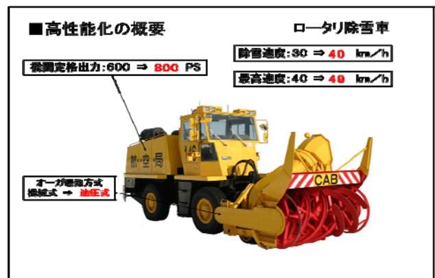
図7 高性能ロータリ除雪車
