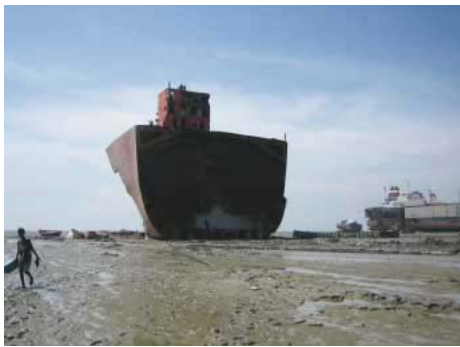
遠浅の海岸に船を乗り上げさせてそのまま解体する。油や有害物質が海へ垂れ流されている。
