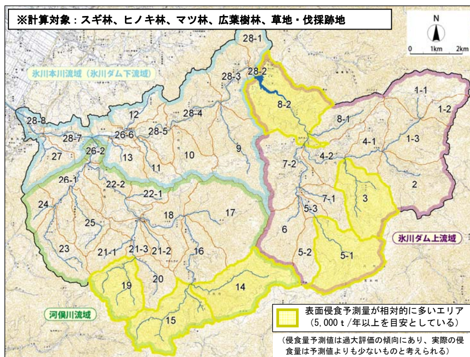
図 3-1 USLE式による土砂流出ポテンシャル評価結果①
