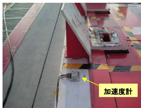
図 5-6 AGV 振動計測
