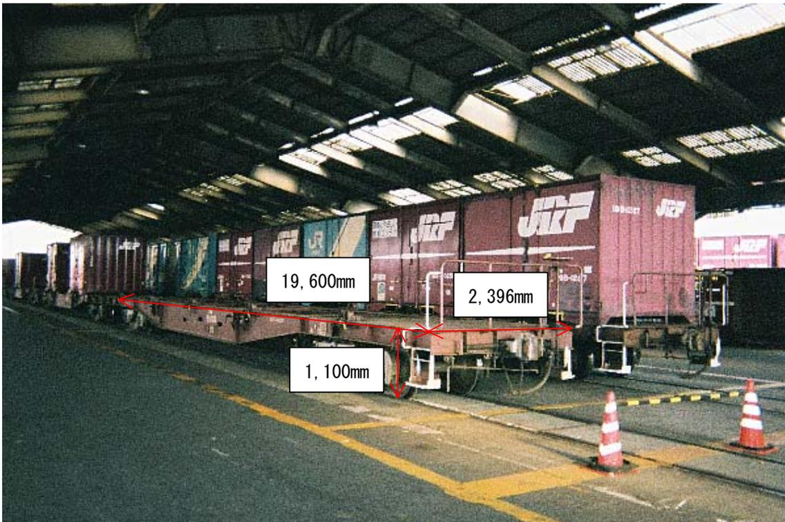
貨車への積載にあたっては、国際海上コンテナに合致した緊締装置が貨車に設置されていることが必要となる。現在は大半の貨車で海上コンテナ向けの緊締装置がつけられているが、依然として一部の貨車では 12ft コンテナへの対応であることから、輸送する線区に対応する貨車を導入する必要がある。
