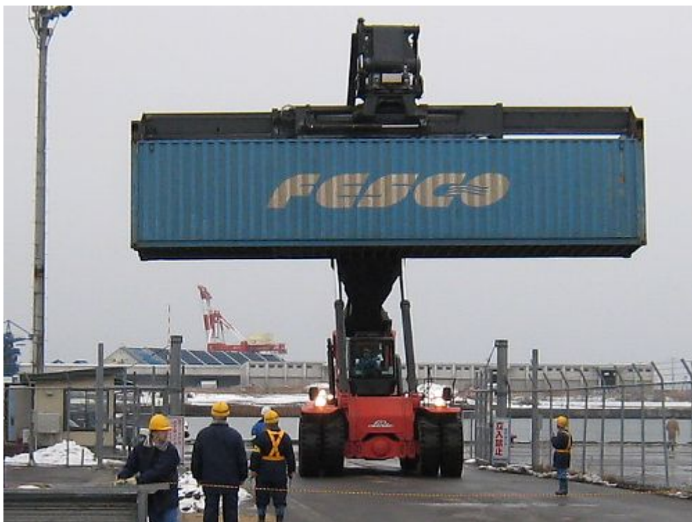
【ゲートからヤード内に入る際、フェンスを越えるためにリーチを上げる】
