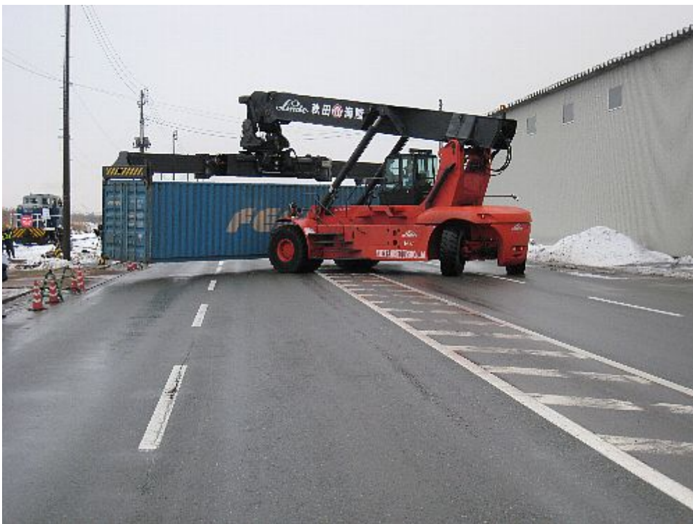
【40 フィートコンテナを掴んだまま臨港道路をコンテナヤードへ後進①】
