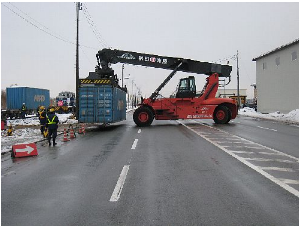
【40 フィートコンテナを掴んで臨港道路へ】
