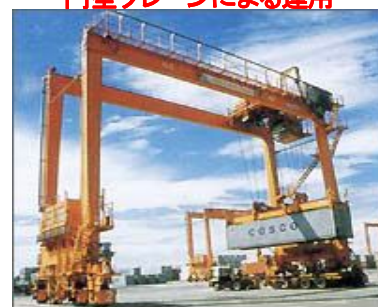
タイヤマウント式 門型クレーンによる運用
