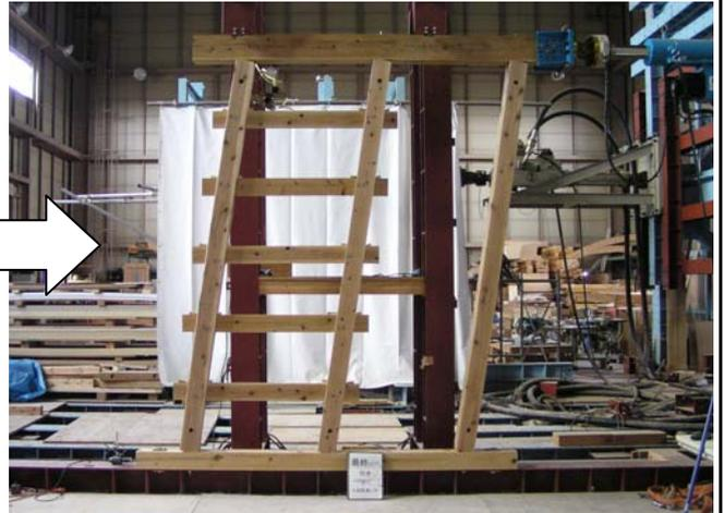
写真2 試験終了時全景 1/7rad(407mm)
