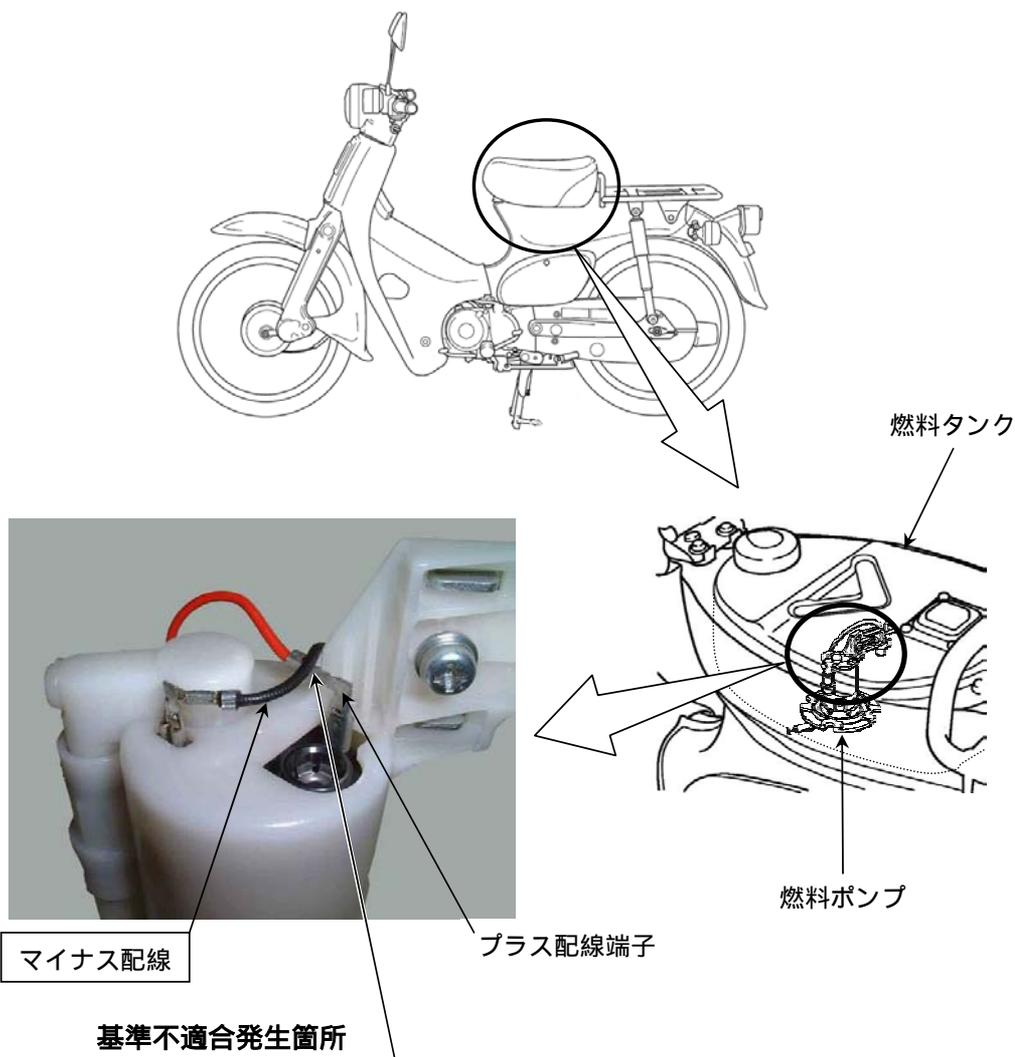
燃料タンク内の燃料ポンプ電気配線の配索が不適切なため、マイナス配線がプラス配線の端子と干渉するものがある。そのため、エンジン振動によりマイナス配線の被膜が剥がれて短絡し、ヒューズが切れてエンジンが停止するとともに、制動灯、方向指示器及び速度計照明の不灯並びに警音器が不鳴となるおそれがある。
