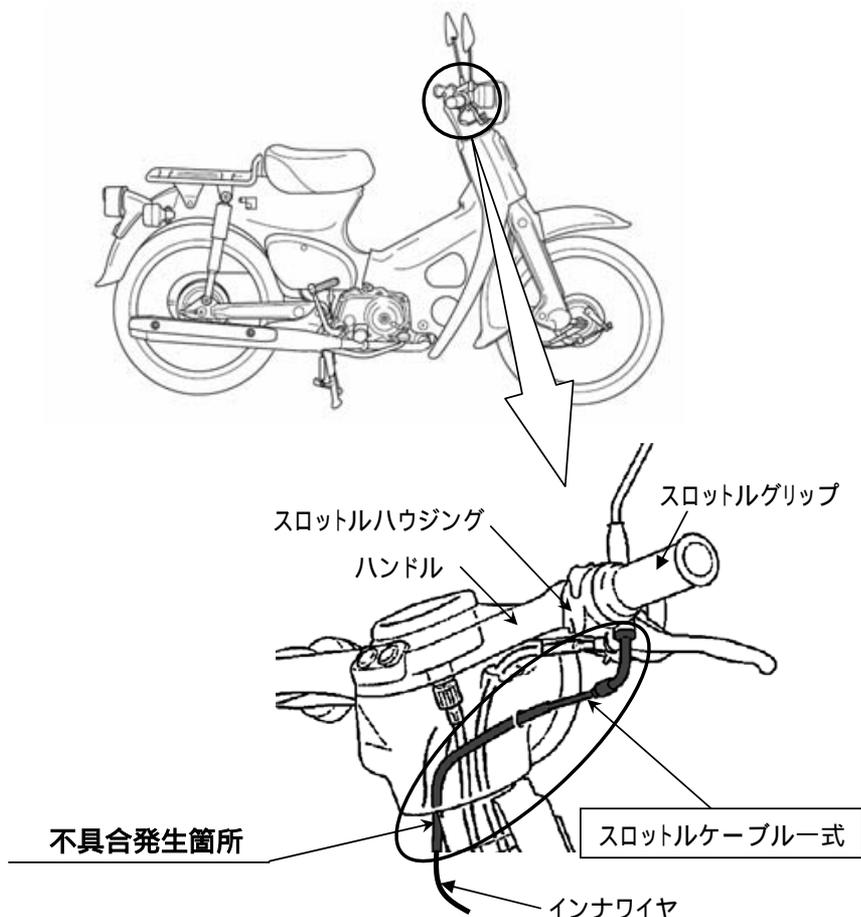
ハンドルに取付けたスロットルハウジングの排水孔位置が不適切なため、洗車等によりハウジング内に溜まった水がスロットルケーブル内部に浸入して滞留するものがある。そのため、そのまま使用を続けると、スロットルケーブル内のインナワイヤが錆びてスロットル操作が重くなり、最悪の場合、エンジンの回転が下がらなくなるおそれがある。
