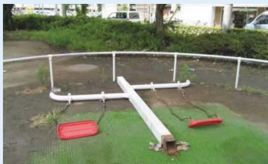
ぶらんこの支柱が根本から破断し遊んでいた児童4名が全治1週間程度のけがを負った。(平成19年7月)
