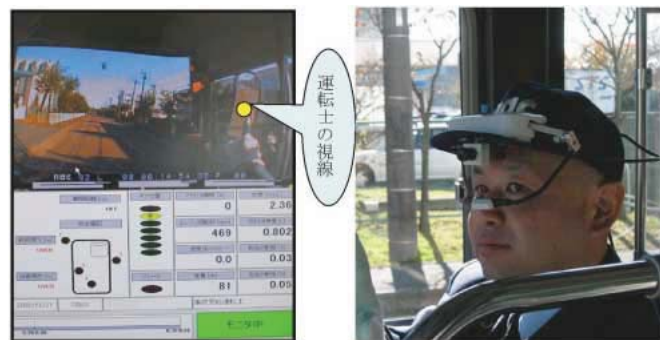
アイマークレコーダーによって指差呼称による目線や運転中の視線、車体の揺れの状況などを記録再生し、乗務員自身が運転操作を確認できる
