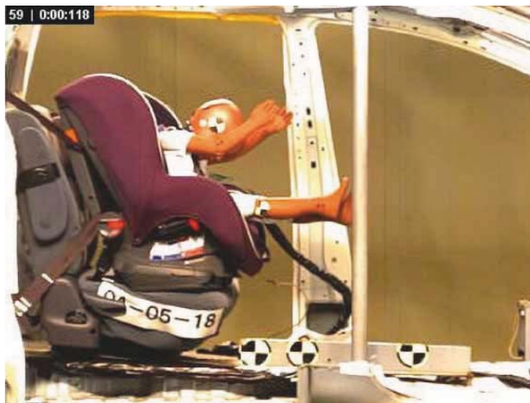
子どもダミーを用いて、衝突時の衝撃を測定
