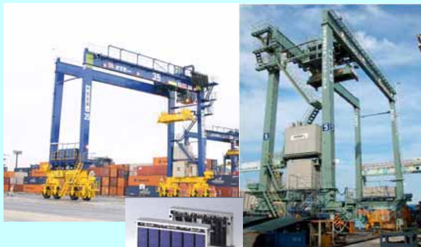
ハイブリッド型トランスファークレーンに搭載されている蓄電装置
