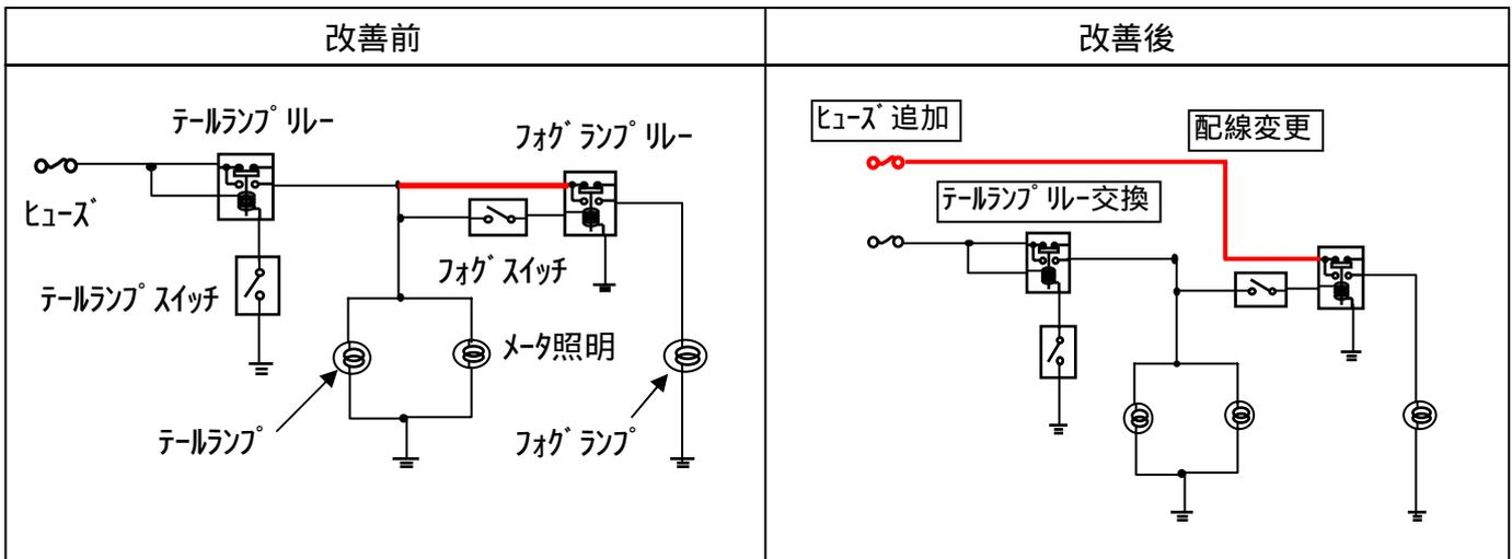
尾灯（テールランプ）及び前部霧灯（フグランプ）の電気回路が不適切なため、テールランプリレーを流れる電流値が大きく、リレーの接点が発熱することがある。そのため、当該部品の樹脂部及びコネクタ部が変形し、そのままの状態で使用を続けると、接触不良を起し、尾灯などが点灯しなくなるおそれがある。
