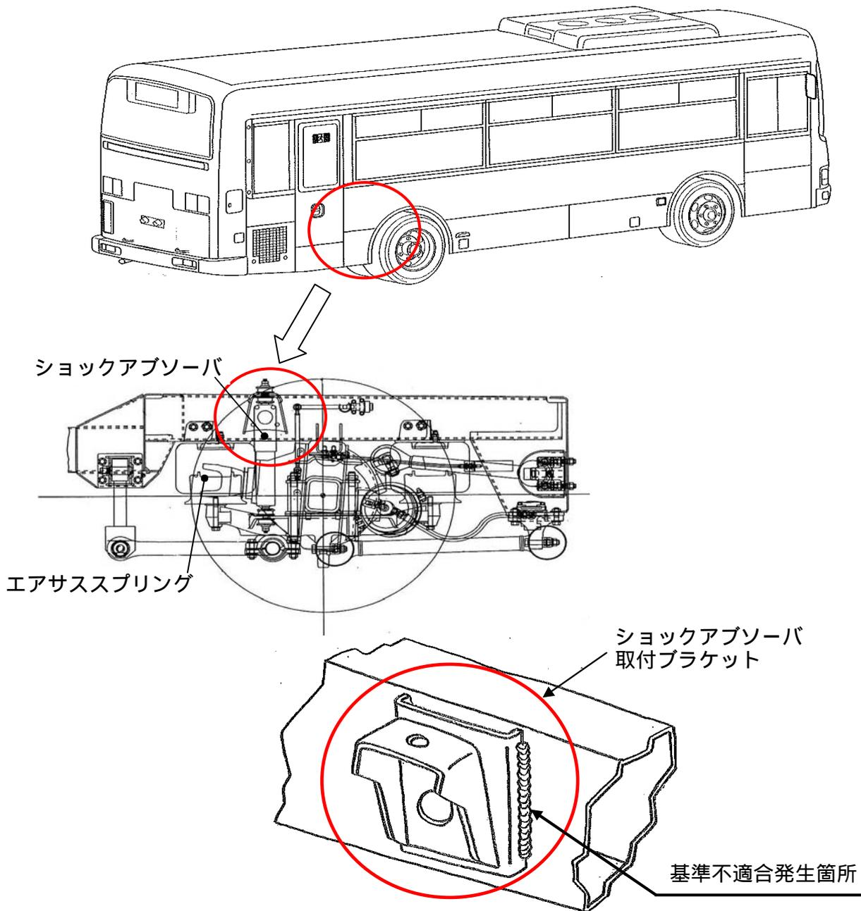
後輪のショックアブソーバ取付ブラケットの溶接が不適切なため、走行中の振動等により当該ブラケットの溶接が剥がれて走行安定性が悪化し、最悪の場合、エアスプリングにブラケットが接触して損傷し、エアが漏れて車体が傾くおそれがある。
